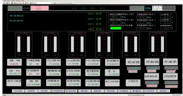
图 10 SYN FLOOD 攻击后甩负荷控制画面
