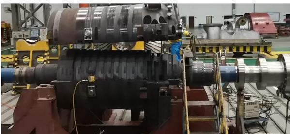
图 2 筒形汽缸返厂检修拆解
