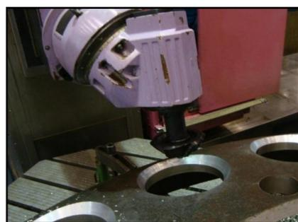
图8 玉米倒角铣刀铣外侧焊接坡口接
