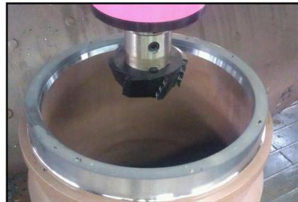
图5 玉米倒角铣刀铣管口内孔倒角
