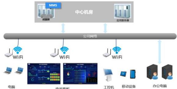
图7 MMS软件网络架构图
