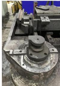
图 3 侧助推弯管机及弯管模具
