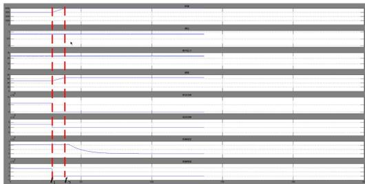
图 16 保护失效后强制解列汽轮发电机运行结果
