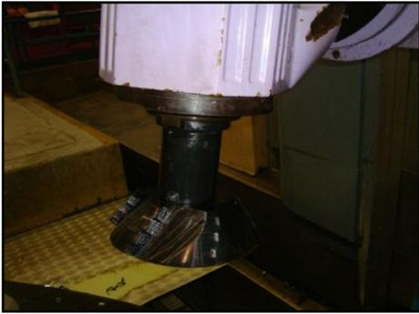
图9 装玉米倒角铣刀铣内侧焊接坡口
